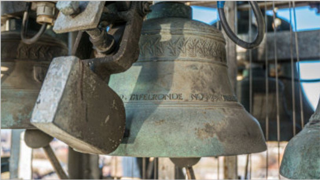
Elektromagnetische hamer van de oude beiaardautomaten.
