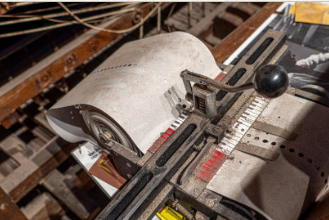
Ponsmachine voor het maken van de speelbanden voor de eerste automaat van de Heikese toren.
